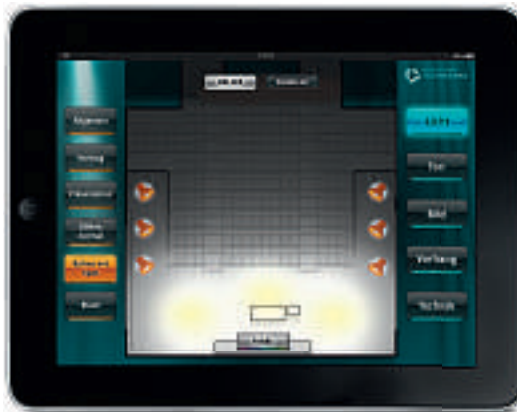
Über sechs Bühnenscheinwerfer können spezielle Effekte erzeugt werden, inklusive Visualisierung auf dem Bildschirm. (Bilder: Omalik/Technorama)
